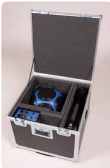
Valise de transport robuste Nor1327B avec des compartiments pour le haut-parleur dodécaèdre Nor276, le trépied, l'amplificateur de puissance Nor280, le sonomètre Nor140 et accessoires divers.
