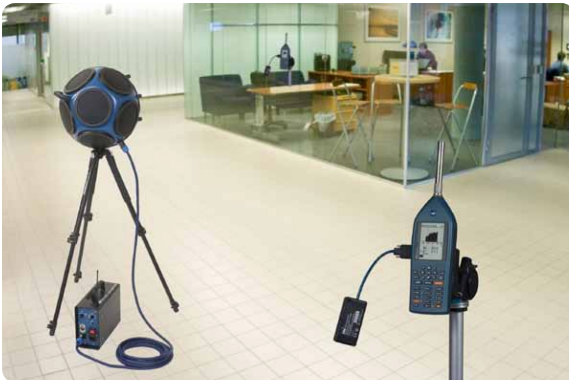
Le haut-parleur dodécaédrique Nor276 et l'amplificateur de puissance Nor280 in situ avec un sonomètre Nor140 équipé d'un module Bluetooth sans fil pour la transmission de données entre les pièces d'émission et de réception.
